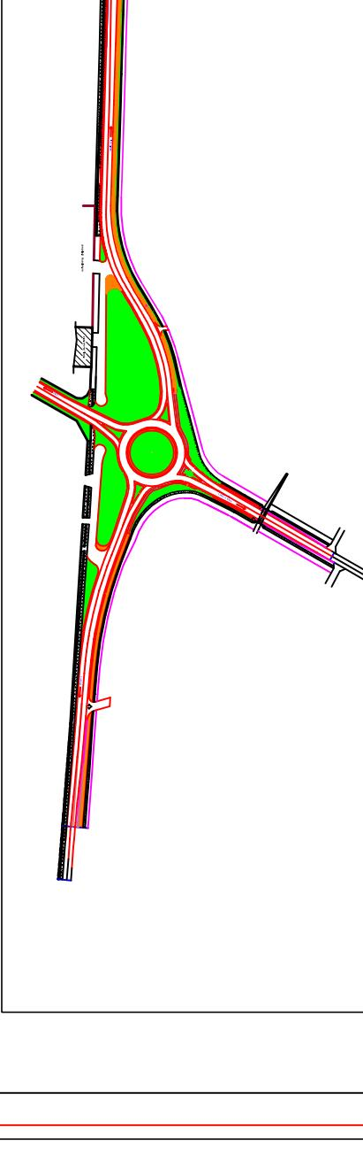
PROGETTO: LAVORI OCCORRENTI PER LA COSTRUZIONE DI UNA ROTATORIA A RASO AL Km 386 + 00-SULLA SS. N° 18 "TIRRENA INFERIORE" IN LOCALITÀ "ACCONIA DI CURINGA"
